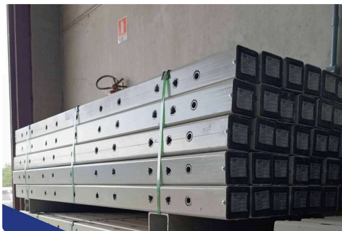
Crucetas de PRFV listas para despacho.
